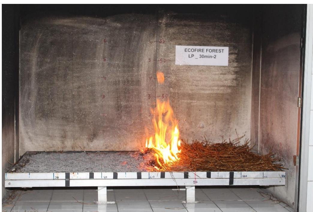
Fotografía n° 2.- Vista del avance del fuego antes de entrar en la zona tratada, para el tratamiento 1 (30 minutos en estufa)
