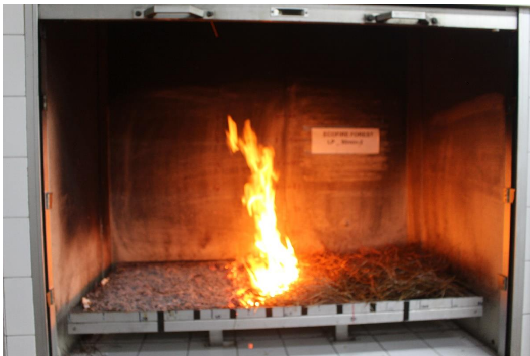
Fotografía nº 7.- Vista del avance del fuego en la zona no tratada para el tratamiento 2 (90 minutos en estufa)
