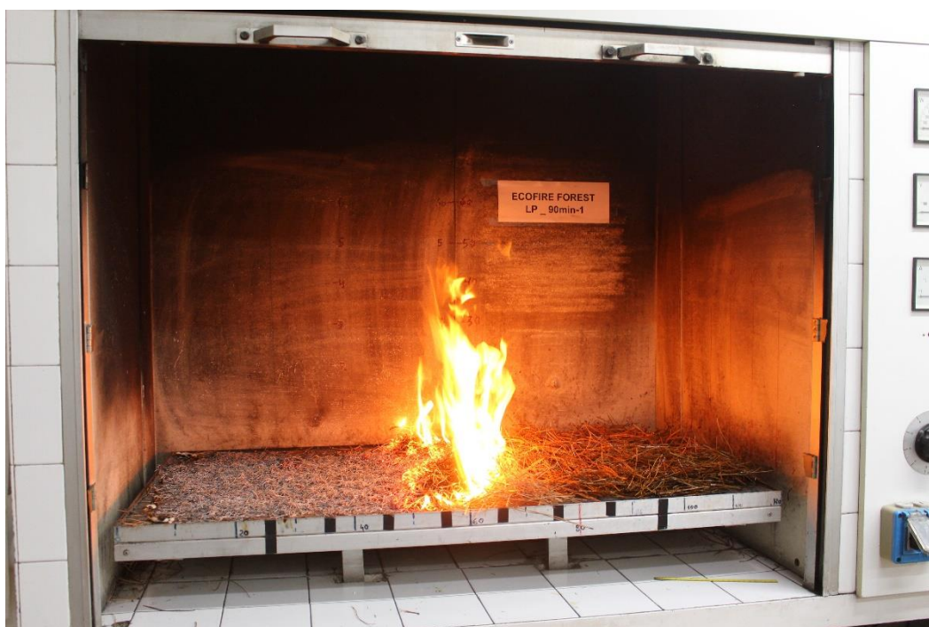
Fotografía nº 8.- Vista del avance del fuego antes de entrar en la zona tratada para el tratamiento 2 (90 minutos en estufa)
