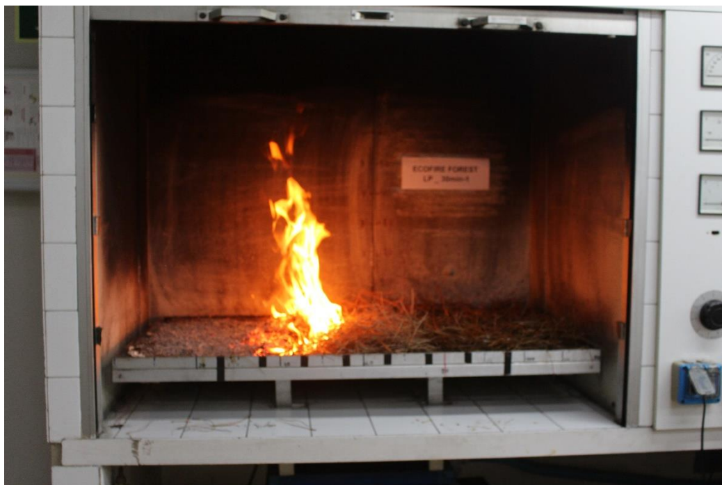
Fotografía n° 1.- Vista del avance del fuego en la zona no tratada, para el tratamiento 1 (30 minutos en estufa)
